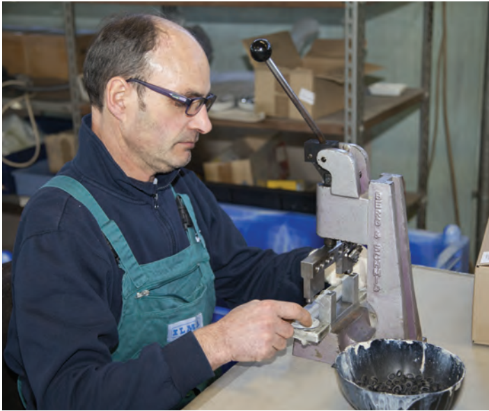
Particolare montaggio bussole
